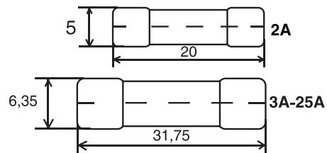
**Предохранители со светодиодным индикатором**
